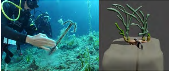
Figure 1 : Images du pieu composé de tiges de fer de 0.6 cm de diamètre soudé en un ou plusieurs points, chacune étant incurvée à une extrémité pour former deux bras courbes (croissants) contenant les rhizomes de P. oceanica .
